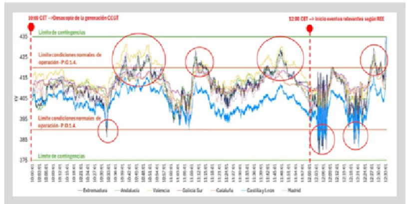
En la mañana del 28 de abril, Red Eléctrica de España (REE) ejecutó [4] varias maniobras para intentar amortiguar las oscilaciones de tensión: (i) reconexión de líneas que llevaban días desconectadas y (ii) desconexión de reactancias. Minutos antes del colapso, REE cambió el modo de operación de la interconexión HVDC con Francia a "Potencia DC constante", abandonando el modo de emulación AC utilizado hasta ese momento.
