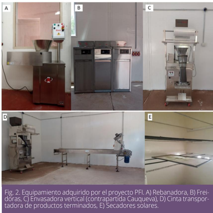
Fig. 2. Equipamiento adquirido por el proyecto PFI. A) Rebanadora, B) Freidoras, C) Envasadora vertical (contrapartida Cauqueva), D) Cinta transportadora de productos terminados, E) Secadores solares.
