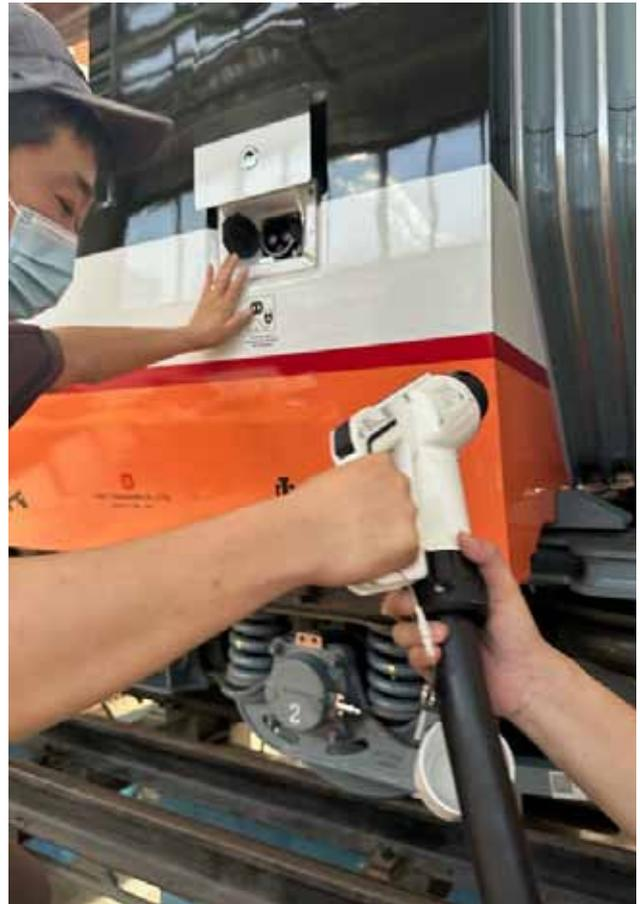
Sistema de carga externo de baterías
